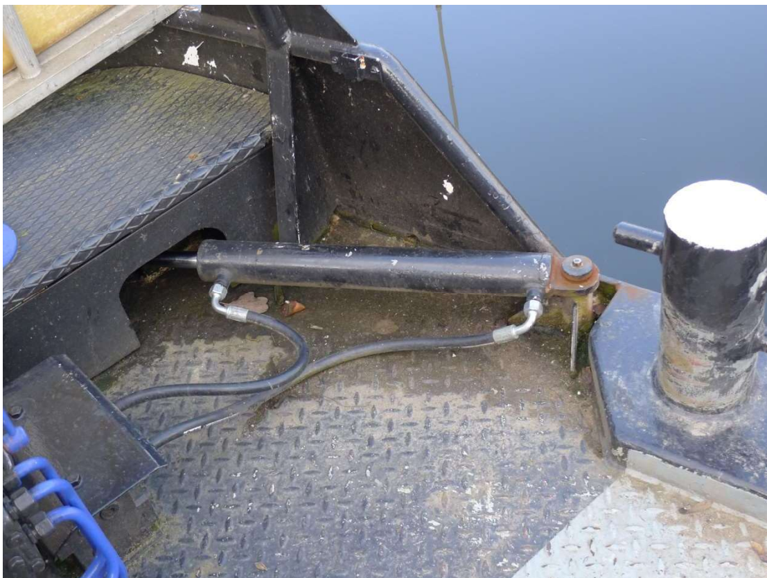
Obr.3 – hydraulické ovládání kormidla
