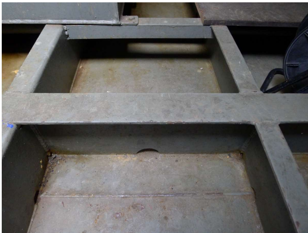
Obr.8 – systém vyztužení - páteřnice a dnové příčky
